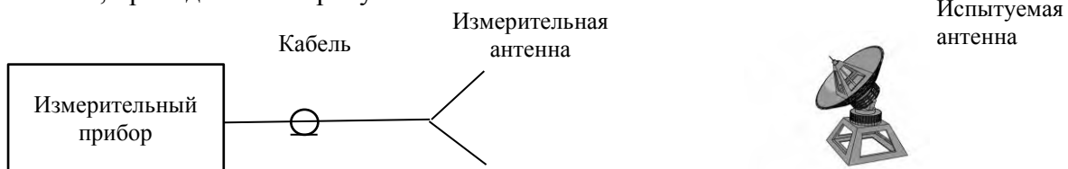
Рисунок 5 – Схема соединения приборов при измерении плотности потока энергии
