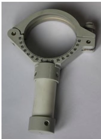
Рисунок 2 – Общий вид кронштейна АК-02 для крепления рупора
